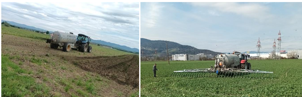
Slika 1: Razvoz gnojevke z razpršilno ploščo (levo) in z razdelilnimi vlečnimi cevmi (desno)
