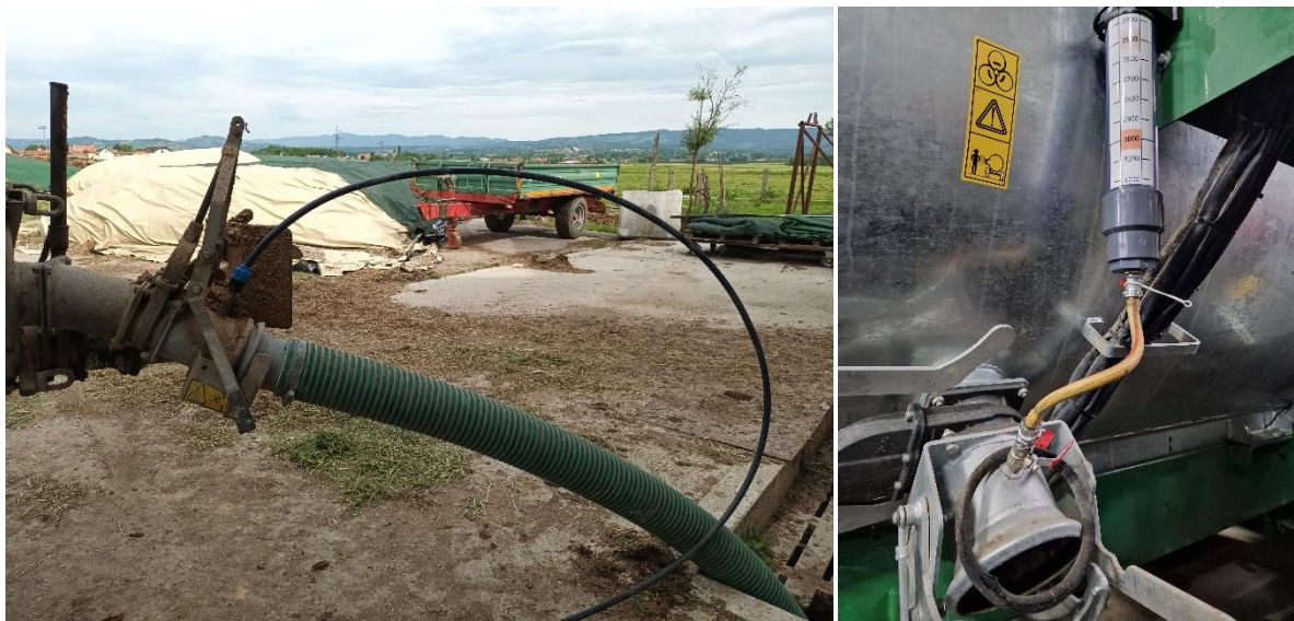
Slika 2: Različni načini doziranja tekočih tretirnih sredstev v cisterno
