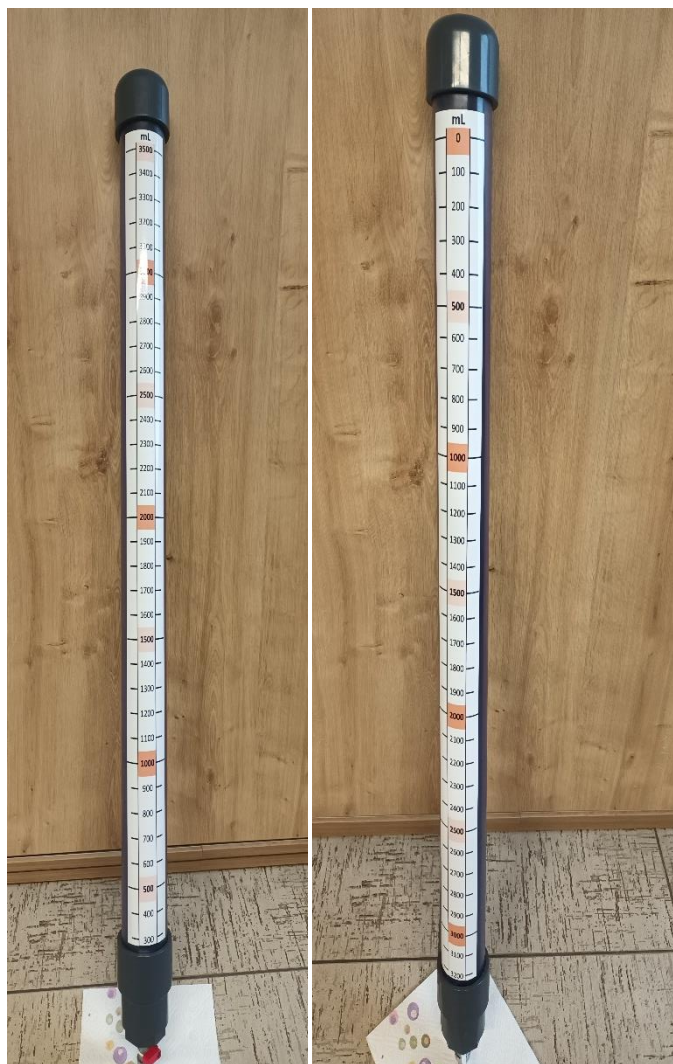
Slika 3: Dozirna naprava za sredstva tretiranje gnojivke z dvema merilna skalama
